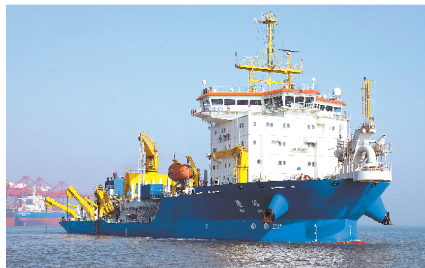
河北唐山:海上交通重点项目疏浚忙 2月6日,一艘施工船在唐山港京唐港区25万吨级航道工程海域进行疏浚作业(无人机照片)。近日,国家交通运输部重点支持项目——唐山港京唐港区25万吨级航道工程采用多艘大型专业化疏浚船舶同时作业的方式加紧对航道进行疏浚施工。据介绍,该项目于2018年5月开工建设,航道全长31.7公里,航道通航宽度270米,项目建成后京唐港区可实现20万吨级散货船全天候进出港,25万吨级散货船乘潮进出港。新华社发
