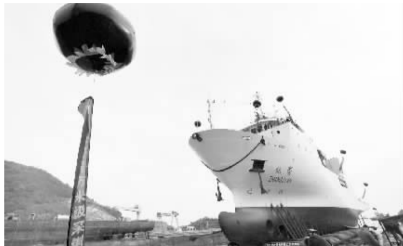
我国万米级载人深潜器科考母船“张謇”号成功建造 3月24日,“张謇”号科考母船举行上水仪式。当日,我国万米级载人深潜器的科考母船“张謇”号成功建造,在浙江温岭举行上水仪式。“张謇”号,船长97米,船宽178米,设计排水量4800吨,设计吃水5.65米,巡航速度12节,续航力15000海里,载员60人,自持能力60天。新华社发
