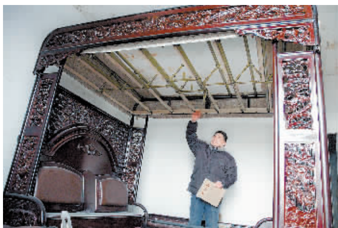
防震床上面的这层钢管能防5块楼板砸击
