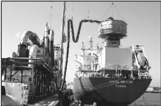
2008 年 6 月 19 日,美国加利福尼亚州长滩港口的一艘货轮烟囱被“戴上”一顶“帽子”。原来,这顶特殊的“帽子”是先进的有毒气体收集处理装置,可以大量减少废气的排放。
