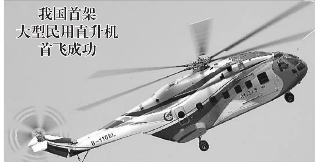
3月18日，AC313大型民用直升机在首飞中进行高难度飞行动作表演。当日，由中国航空工业集团公司自主研制的AC313大型民用直升机在江西景德镇首飞成功。作为我国第一个大型民用直升机，该机最大起飞重量13.8吨，可一次性搭载27名乘客或运送15名伤员，最大航程为900公里。整机性能达到国际第三代直升机水平，填补了我国大型民用直升机研制的空白，使中国和欧、美、俄一样具备自主研制大型直升机的能力。
