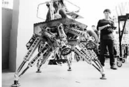
10月28日,由上海交通大学研发的具有自主知识产权的“六爪章鱼”救援机器人亮相。“六爪章鱼”机器人高约1米,由18个电机驱动,通过远程遥控使用,能够灵活地沿各个方向稳定行走,速度可达1.2千米/小时,负重达200公斤。
