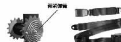
安全带最核心的部件是隐藏在B柱内的卷收器,卷收器的发明省去了乘员手动调整安全带长度的麻烦,卷收器与安全带好带扣一端相连,由内部的预紧弹簧承担收紧安全带的力量,从而实现了安全带机械化的自动调整长度的功能。
